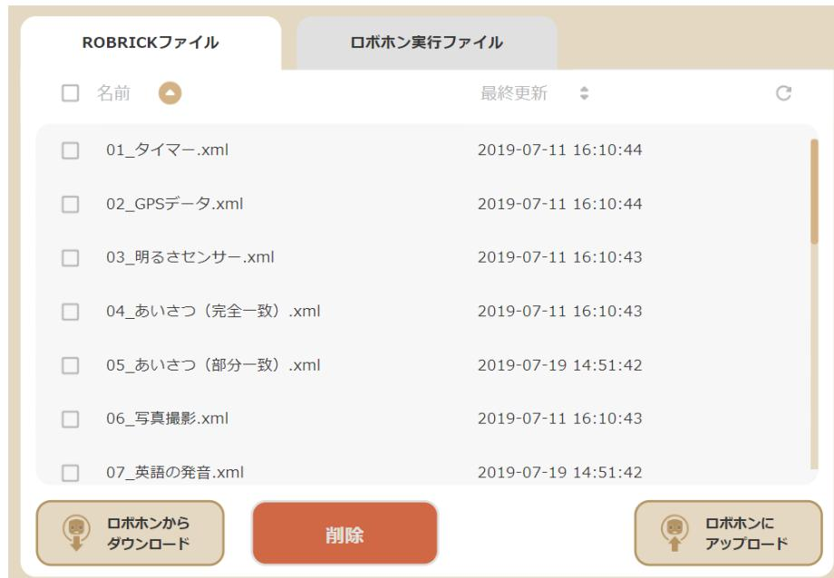
“ロボホンからダウンロード”ボタンは、チェックしたプログラムをロボホンから端末にコピーします。
